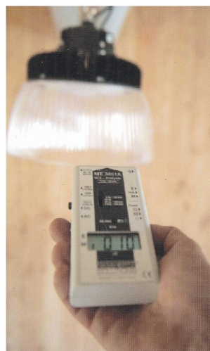
Mesure des champs électromagnétiques générés par un appareil électrique
